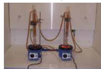
Fig. 2 Bagno di prova secondo UNI EN 579 Test bath according to UNI EN 579
